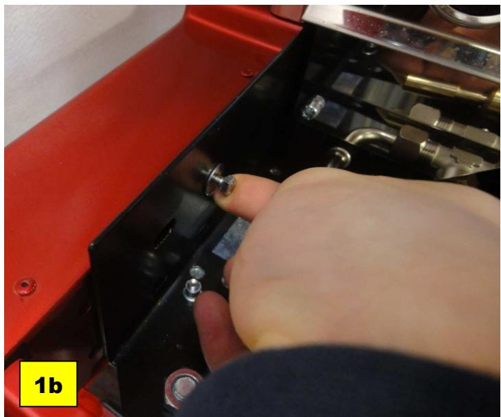
**Svitare e togliere le 2 viti inferiori di fissaggio del pannello laterale.
